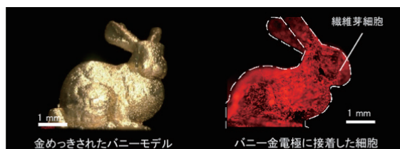
超高精細3Dプリンタで作製した3D鋳型によって3D細胞シートを作製 (丸尾研究室と福田研究室の共同研究)
