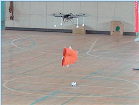
ライフジャケットを投下するマルチローター機
