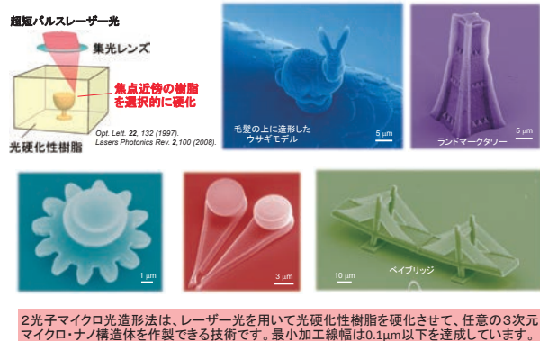
図1 2光子マイクロ光造形法
