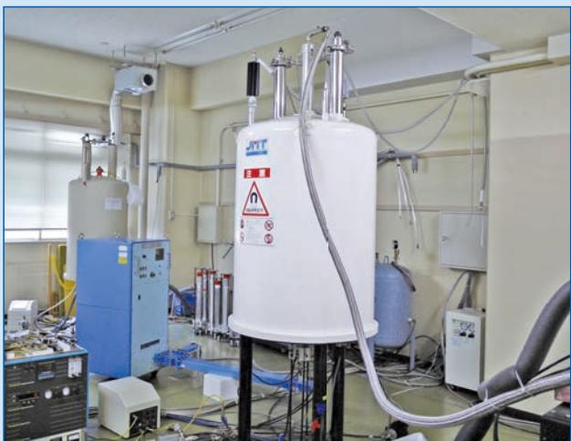
図1. 固体NMR装置(CMX Infinity 400、Chemagnetics 製)
